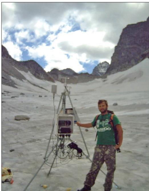
Рис. 2.1.3. Снятие показаний с автоматической метеостанции Campbell-2000, установленной на леднике Азаровой (хребет Кодар) в рамках проекта ИНТАС, 2008 г. Фото В.С. Шейнкмана
