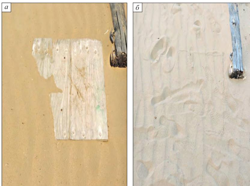
Рис. 2.14. Переживание песка по поверхности в с. Нижний Цасучей (долина р. Онон) за дефляционно-опасный период апреля 2015 г.: *а* – начало засыпания песком доски 19 апреля, *б* – она же, полностью занесенная песком, 24 апреля (фото Н.Н. Рогалевой)
