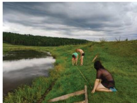
Определяем створ реки для вычисления скорости течения
