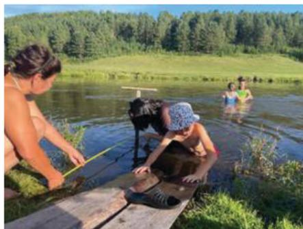
Измеряем ширину и глубину реки для определения дебита
